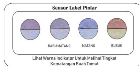
Gambar 1. Membran bagian atas dengan kombinasi indikator bromofenol biru dan metil merah. Membran bagian bawah indikator bromofenol biru.
